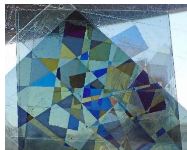
図 7 (左) セロファンテープを通る光の振動方向
