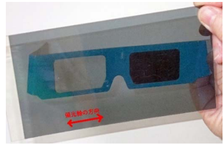
図 12 偏光板を通して見た立体視用簡易メガネ
