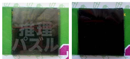
図 2 偏光板の重ね合わせ。左はスリットの方向をそろえたもの。右側は直交する位置に置いたもので光が通らないため下の字は見えません。
