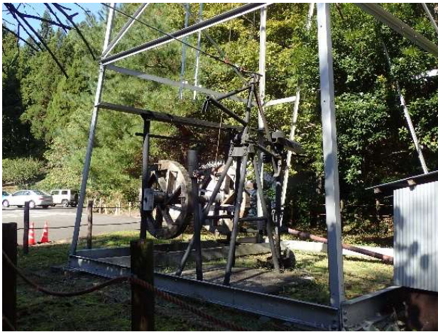
図8 C86号井 Cは綱式機械掘りを示す
