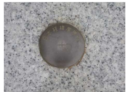
図 6 日本経緯度原点（左の写真の標示板の右側の円い点（右側写真）が原点を示しています）
